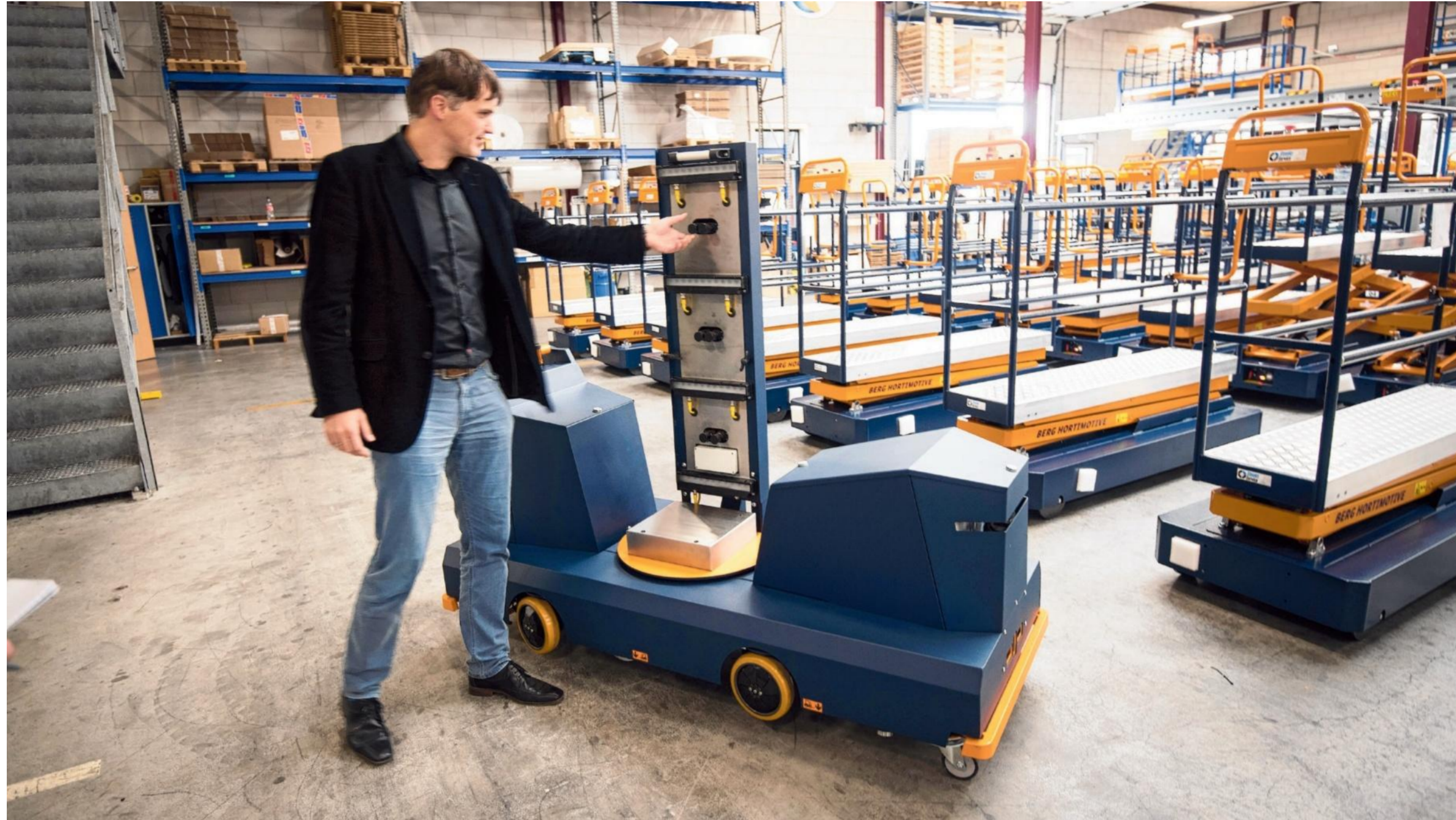
De Plantalyzer van Berg Hortimotive in De Lier kan bepalen wat het beste moment is om een tros tomaten te plukken, zodat er zo min mogelijk weggegooid hoeft te worden.
