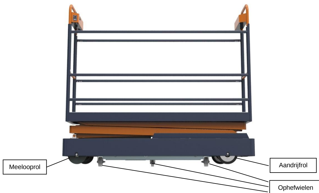
Figuur 5.2; Benaming van de onderdelen aan de onderzijde van de BeNomic Star PRO 350
