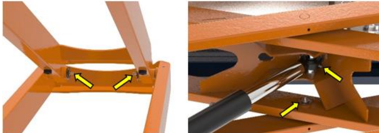
Figuur 9.2; Positie van de smeernippels voor de schaarassen en de cilinderstangkop
