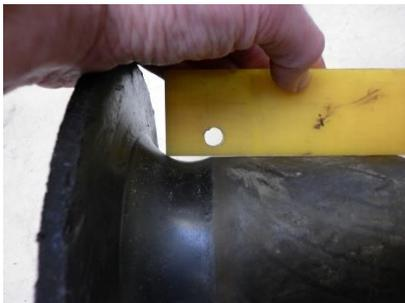
Износ 2-3 мм; ролики по-прежнему в порядке.
