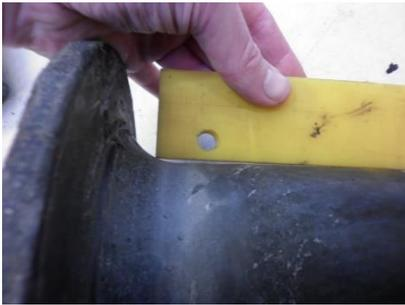
Износ примерно 1 мм; ролики эксплуатировались некоторое время.
