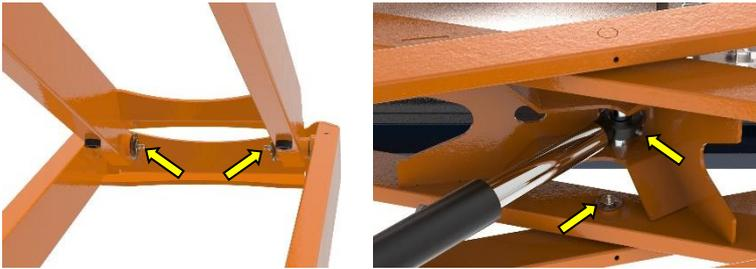
Abbildung 9.2: Position der Scherenwellen und der Schmiernippel für die Zylinderstangenköpfe
