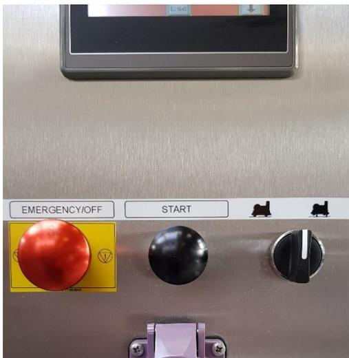
Drehen Sie den Knopf nach rechts, um das Löschesystem zu aktivieren. Bewegen Sie den *BeMatic Meto SW* und drehen Sie den Knopf nach links, um das Hebesystem vollständig einfahren zu lassen, bis ein grüner Pfeil auf dem Bildschirm angezeigt wird.
