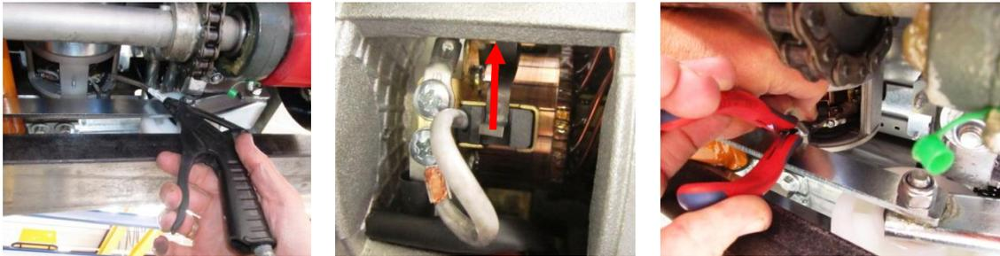
1) Den Motor mit (trockener) Luft reinigen. 2) lösen Sie die Bürstenfeder 3) und ziehen Sie die Bürste am Draht vom Halter.
