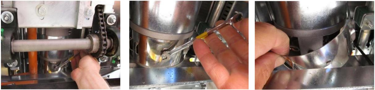
Entfernen Sie die Bürstenabdeckung mit dem 8mm Schraubenschlüssel.
