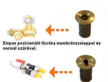
Homlokzati fúvóka membránszelep nélkül, ezért önzáró szűrőt tartalmaz.
