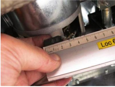
Un balai de carbone de moins d'un centimètre de long doit être remplacé, consultez votre revendeur.
