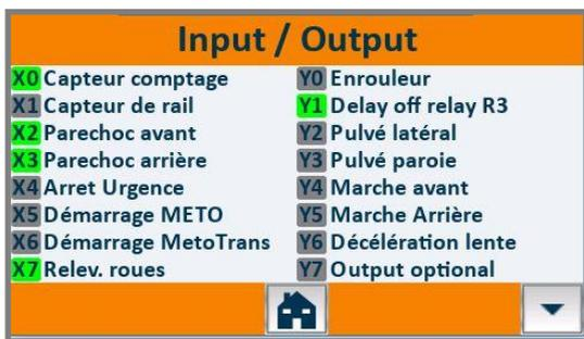
Sur l'écran des entrées, il est possible de voir si des entrées sont actives, ou le seront quand vous actionnerez l'interrupteur. Ceci est utile en cas d'alarme.
