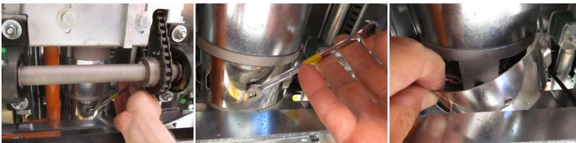
Démontez les balais avec une clé plate de 8 mm
