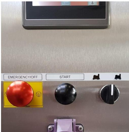
Ruota la manopola a destra per attivare il sistema di cancellazione. Spostare il *BeMatic Meto SW* e ruotare la manopola verso sinistra per far entrare completamente il sistema di cancellazione fino a quando viene emesso un segnale acustico.
