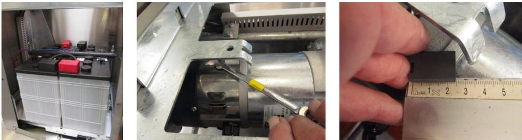
Riportare il *BeMatic Meto SW* sul pavimento, rimuovere le batterie e ripetere la procedura per le 2 spazzole di carbone sul lato superiore del motore.
