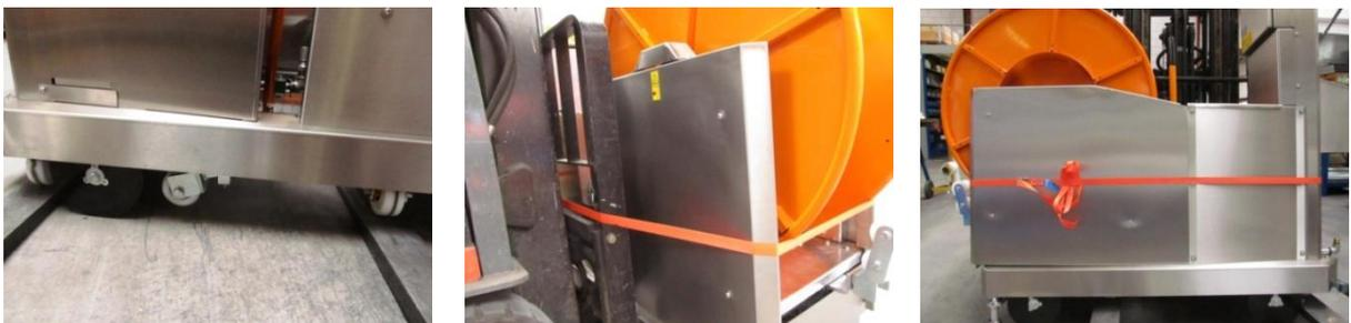
Sollevare il *BeMatic Meto SW* inserendo la forca del muletto sotto le ruote di sollevamento, utilizzare una fascia adeguata per fissare il *BeMatic Meto SW* alla forca del muletto.
