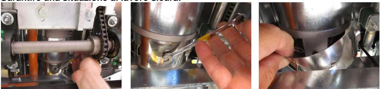
Smontare la calotta protettiva della spazzola di carbone con una chiave da 8 mm.
