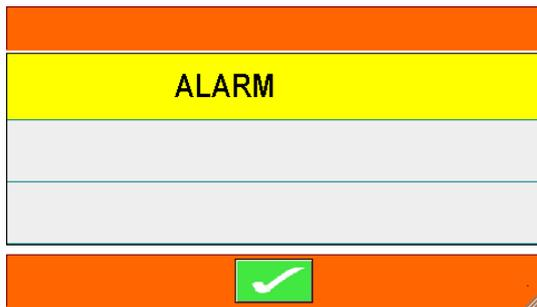
In modalità automatica, sullo schermo possono essere visualizzati messaggi di allarme; ripristinarli sempre premendo il tasto con il segno di spunta verde.
