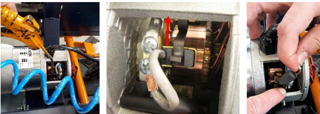
1) Pulire le spazzole di carbone con aria compressa (a secco). 2) Spingere la molla della spazzola di carbone per aprirla 3) ed estrarre la spazzola di carbone dal supporto afferrandola per la filettatura.
