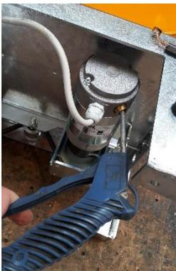
1) Pulire le spazzole di carbone con aria compressa (a secco). 2) Richiedere al proprio rivenditore la sostituzione delle spazzole se risultano più corte di 1 cm.
