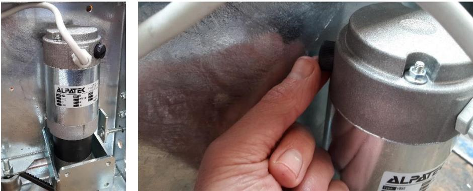
Smontare le coperture delle spazzole di carbone ed estrarre con cautela le spazzole di carbone dai supporti.
