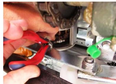
1) Продуйте двигатель чистым (сухим) воздухом. 2) Отпустите пружину щетки 3) Вытащите щетку за проволоку из держателя.
