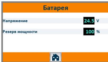
На экране ЗАРЯД БАТАРЕЙ можно проверить уровень зарядки. 100% означает, что батарея полностью заряжена; чем ниже остаточная емкость, тем ниже уровень зарядки батарей.
