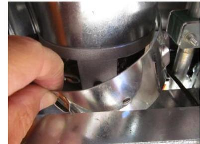
Снимите крышку щеток с помощью 8-мм ключа.
