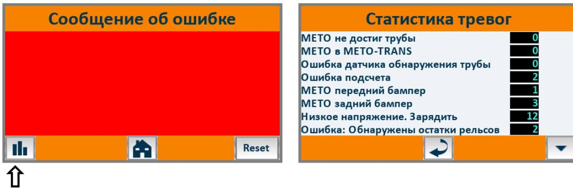
Предыдущие сбои отображаются на экране аварийных сигналов при нажатии кнопки статистики.
