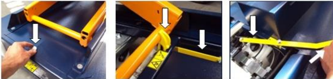
図 6.5; 左: ボルトを緩めて、カバーを取り外します。中央 - ハンドルを取り外します。右 - 隙間にボルトを入れ、緊急下降バルブのピンに押しつけます!
