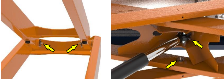
Рисунок 9.2. Положение осей ножниц и смазывающих ниппелей головки штока
