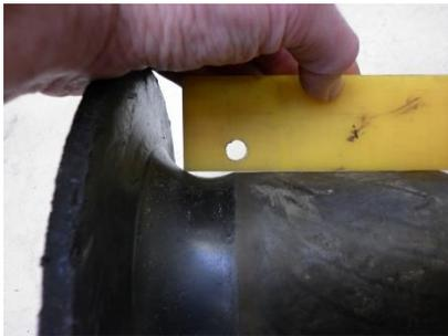
El desgaste es de 2-3 mm; los rodillos siguen estando bien. Mantenimiento normal, inspección de cuerdas alrededor. Aún no es necesario el reemplazo de las ruedas.
