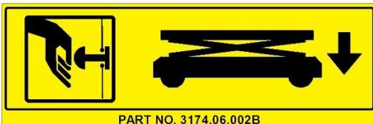
Si el mecanismo de tijeras deja de descender con los controles en la plataforma (9), pero no con los controles del borde delantero del BeNomic Star 300 (2), se deberá poner la palanca de la válvula de descenso de emergencia en la posición indicada por la flecha.
