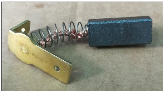
Figuur 5d: Koolborstels inspecteren
