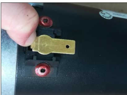
Figuur 5d & e: Koolborstels monteren
