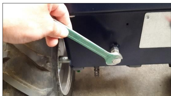
Figuur 10: Spannen ketting
