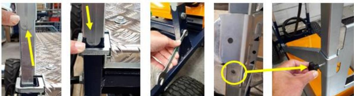
Montez les quatre montants et serrez les huit boulons à l'aide d'une clé de 17 mm, tout en notant les encoches indiquées. Un montant est doté d'un trou fileté, il doit être monté au niveau des roues motrices.
