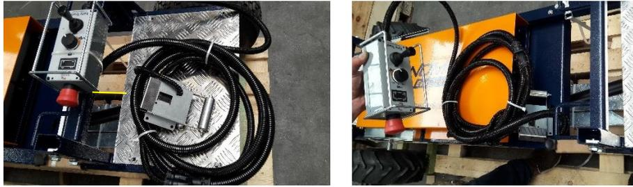
Coupez les attaches des câbles et tirez le câblage sous le châssis tubulaire.
