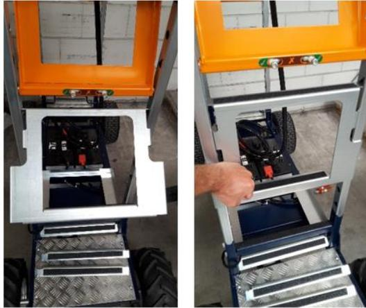
Si la plateforme est suffisamment haute, montez d'abord les deux marches de stabilisation à l'avant et à l'arrière, si la plateforme est placée plus haut, l'espace peut être comblé par des marches séparées.
