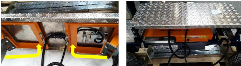
Pliez les entretoises de plateforme et verrouillez-les, placez la plateforme sur les châssis tubulaires.
