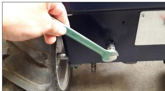
Figure 10 : Tension de la chaîne
