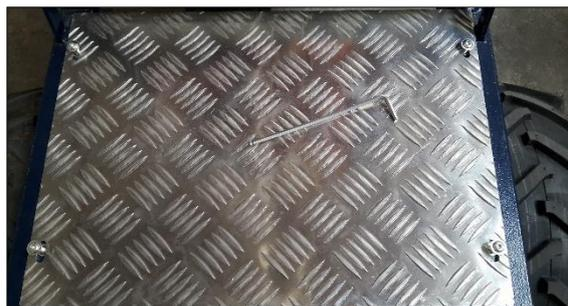
Figure 7 : Démontage de la tôle striée
