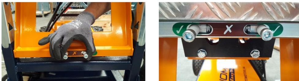
Réglez la plateforme à la hauteur de travail requise (à deux) et, après le réglage, vérifiez que les huit goupilles de verrouillage se sont accrochées dans la position de sécurité verte !
