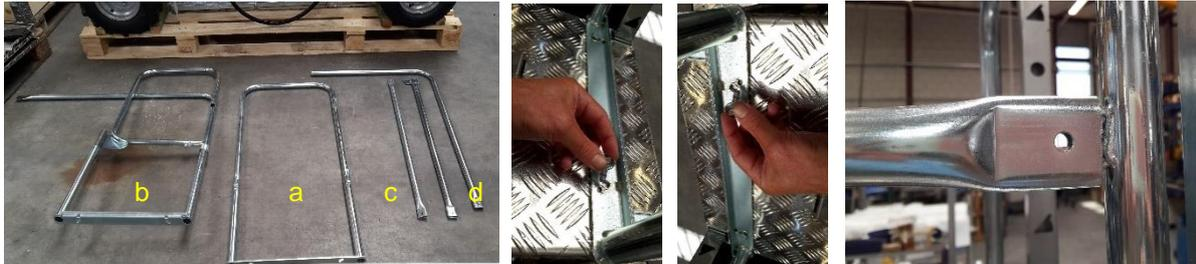
Sortez le rail de sécurité du paquet C et montez la pièce « a » à l'avant et la pièce « b » à l'arrière. Montez également les rails « c ». Serrez maintenant tous les boulons à la main.
