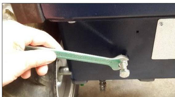
Figure 9 : Desserrage/serrage de l'écrou de verrouillage
