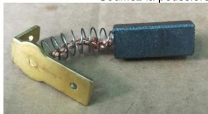
Figure 5d : Inspection des balais de carbone
