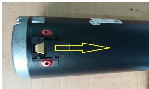
Figure 5b e 5c: Pulire e ispezionare le spazzole di carbone
