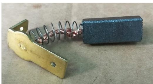
Figura 5d: Ispezionare le spazzole di carbone
