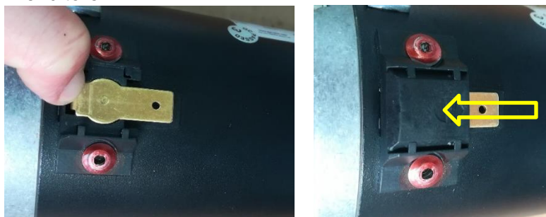
Figure 5d e 5e: Montaggio delle spazzole di carbone
