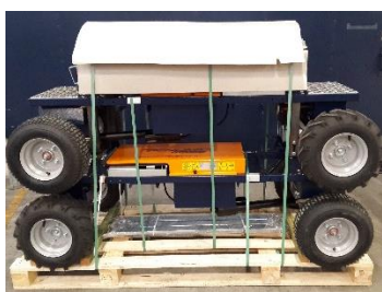
Rimuovere la confezione ed estrarre i carrelli inferiori di BeNomic EasyTrack . (Pacchetto A)
