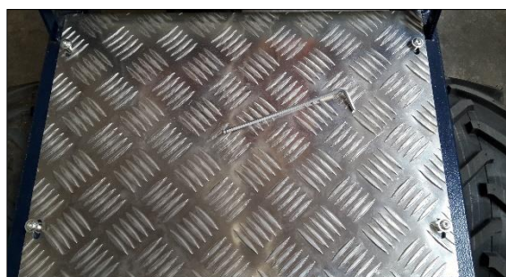
Figura 7: Smontare la lamiera striata
