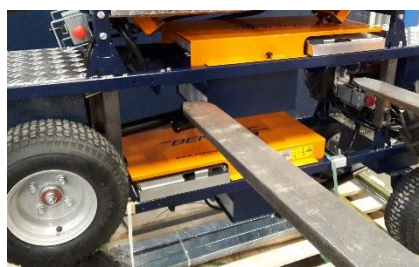
Rimuovere la confezione ed estrarre i carrelli inferiori di BeNomic EasyTrack . (Pacchetto A)
