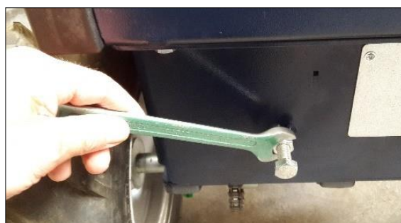
Figura 9: Allentare/serrare il dado di bloccaggio
