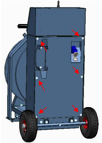
Figuur 9.4; Invetten van geleiderketting en trommellagers
