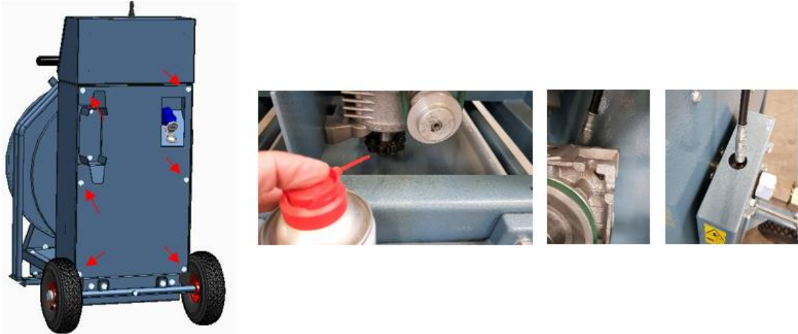
Abbildung 9.4: Schmierung der Kettenführung und der Trommellager
