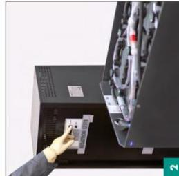
2 Effectuer une charge d'égénéralisation. Les chargeurs de batterie MIDAC MIDATRON effectuent automatiquement l'égénéralisation de la batterie selon une cadence programmée. Pour les chargeurs de 3<sup>e</sup> génération ou d'ancienne génération, prévoir un lancement de charge d'égénéralisation manuel.
