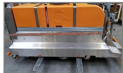
Soulevez *BeMatic Meto SWT* avec le chariot élévateur dans la position indiquée, à l'aide d'une sangle de tension robuste pour fixer *BeMatic Meto SWT* au rail de chariot élévateur.
