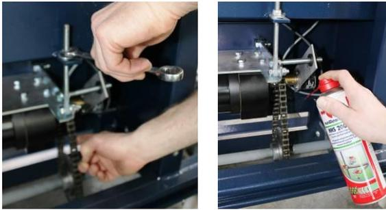
Limpie las cadenas, los engranajes y los rodillos y retire las cuerdas de rodaje y las hojas (cuando sea necesario).
