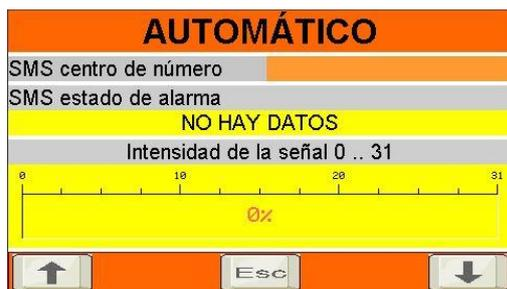
Al pulsar la tecla de flecha hacia abajo en una pantalla de modo AUTOMÁTICO, aparece la pantalla de indicación del módem mencionada anteriormente. La intensidad de la señal debe ser superior a "20" para poder enviar mensajes de forma fiable.
