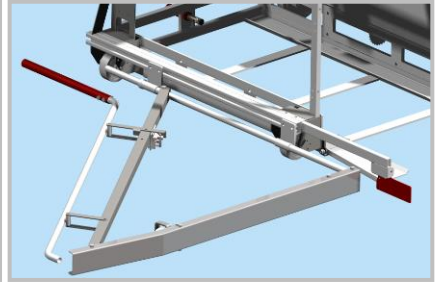
Figuur 7.3; MetoTrans met stuurarm voor geleiding langs de buizen en buisdetectievaan
