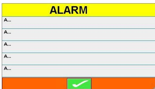
Ein Fehler kann das automatische Programm unterbrechen und die Ursache des Fehlers wird auf dem Bildschirm angezeigt. Um die Fehler zurückzusetzen, drücken Sie die
