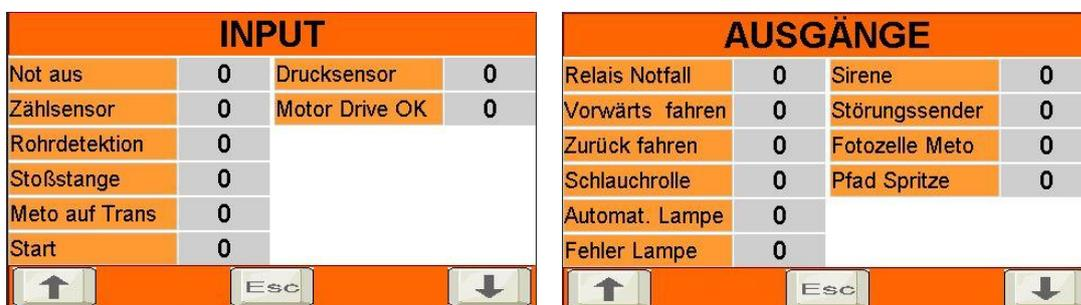
Auf dem **Input-Bildschirm** können Sie sehen, welche Eingänge aktiv sind oder aktiv sein werden, wenn Sie einen Schalter betätigen. Dies ist bei ALARM nützlich.
