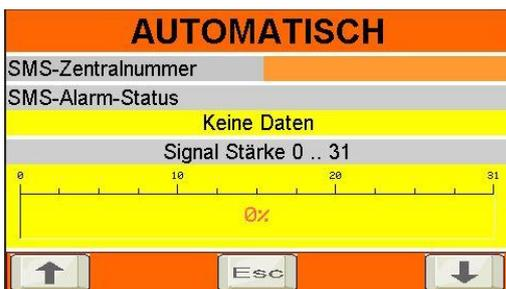
Beim Drücken der Abwärtspfeiltaste in einem AUTOMATISCHEN Bildschirm erscheint der obige Anzeigebildschirm für das Modem. Die Signalstärke muss über „20“ liegen, um Nachrichten zuverlässig senden zu können.
