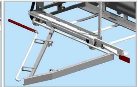
Abbildung 7.3; MetoTrans mit Führungsarm und Erkennungsflosse
