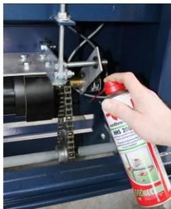
Reinigen Sie Ketten, Zahnräder und Rollen und entfernen Sie Einlaufseile und Blätter (wenn nötig).
