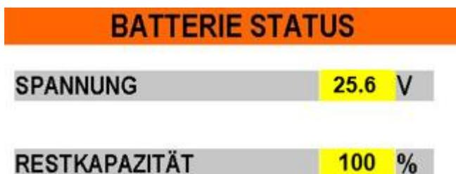
Auf dem BATTERY STATUS-Bildschirm können Sie den Status der Batterien überprüfen. Bei 100 % sind die Batterien voll, je niedriger die Restkapazität der Batterien ist, desto mehr sind sie entladen.
