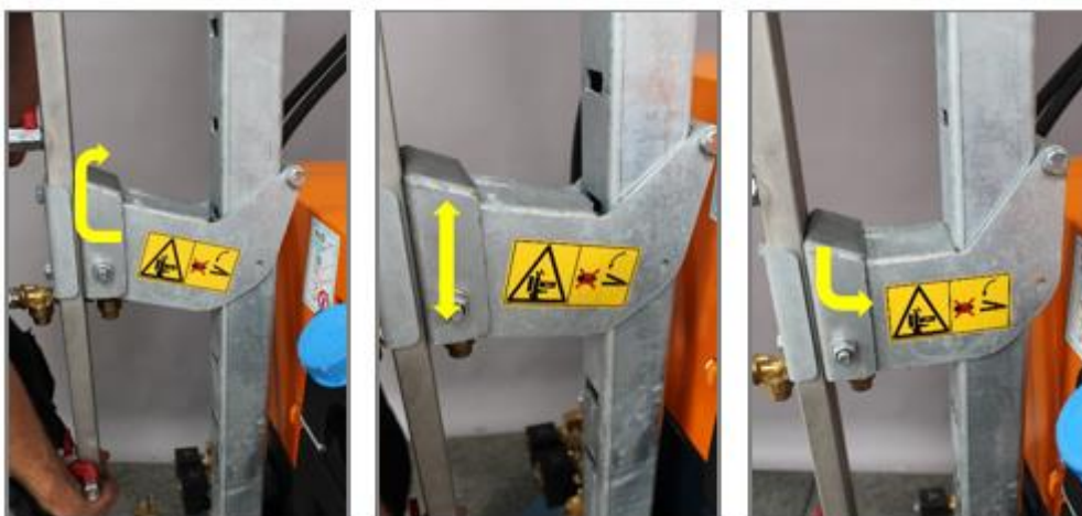
Рисунок 7.2 Регулировка опрыскивательной стрелы
