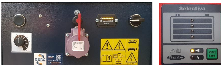
AGV opgeladen en acculader ontkoppeld Figuur 7: Oplaadvoorschriften
